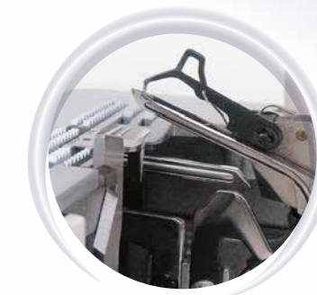
Robuste Greiferkanäle mit klappbarem Hilfgreifer
