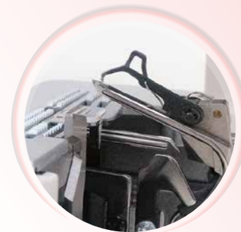
Boucleur surdimensionné avec boucleur auxiliaire intégré
