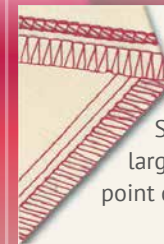
Point décoratif 6 fils 16 mm Couture roulottée combinée au point de recouvrement
