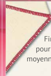
Point de surjet 3 fils large Point de surfilage pour différentes sortes de tissu
